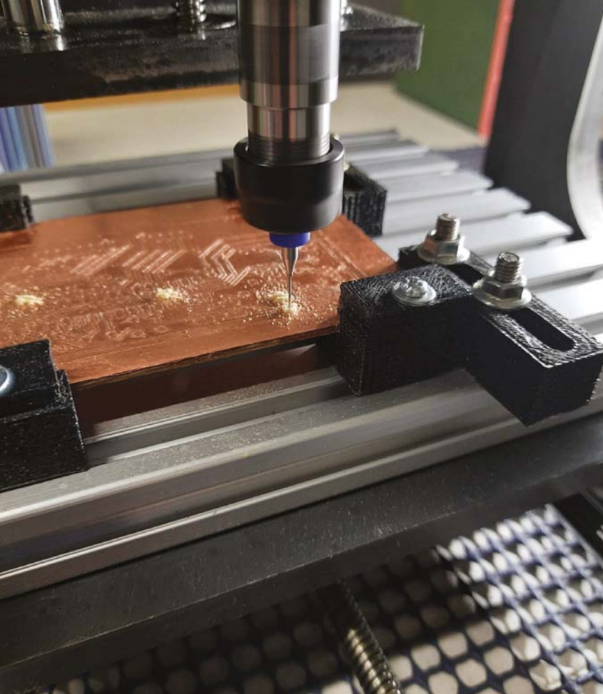
← Fig. 22 CNC in fase di foratura.
