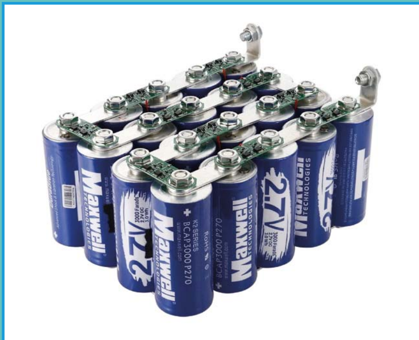
↑ Una batteria di supercondensatori con relativo circuito di carica fra un elemento e il successivo.
