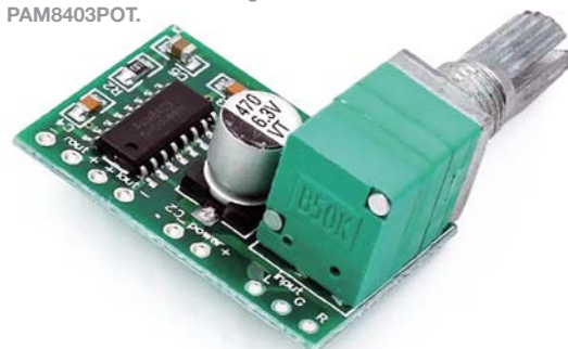
Fig. 11 Modulo PAM 8403 con regolatore di volume PAM8403POT.
