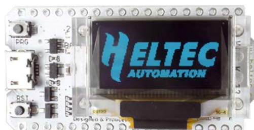
Fig. 2 Il modulo WiFi kit 32 della Heltec.
