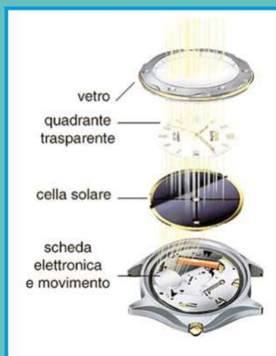
↑ Struttura di un orologio al quarzo Eco-Drive, ad alimentazione fotovoltaica.
