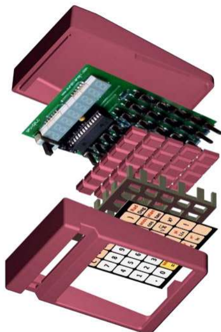
Fig. 2 Assemblaggio del circuito con le parti stampate in 3D.
