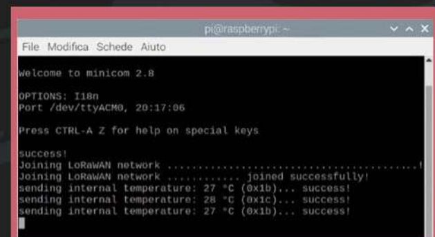
Fig. 3 - Il debug del dispositivo sul terminale.
