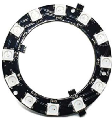
Fig. 1 - L'anello NeoPixel a 12 LED.
