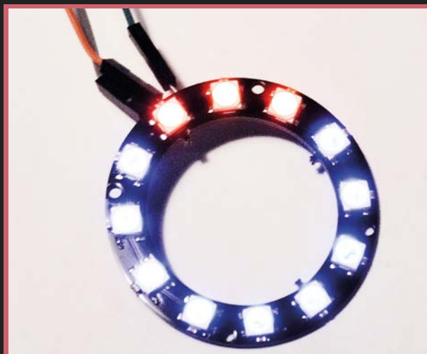
Fig. 8 - I led accesi proporzionalmente alla luce.
