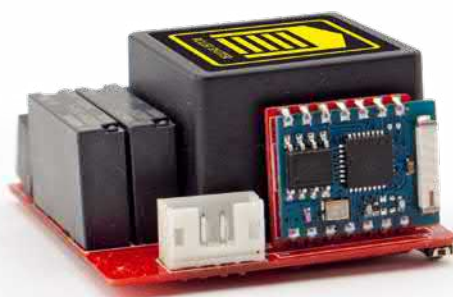
Fig. 2 Montaggio del modulo ESP03 in posizione verticale sul PCB.
