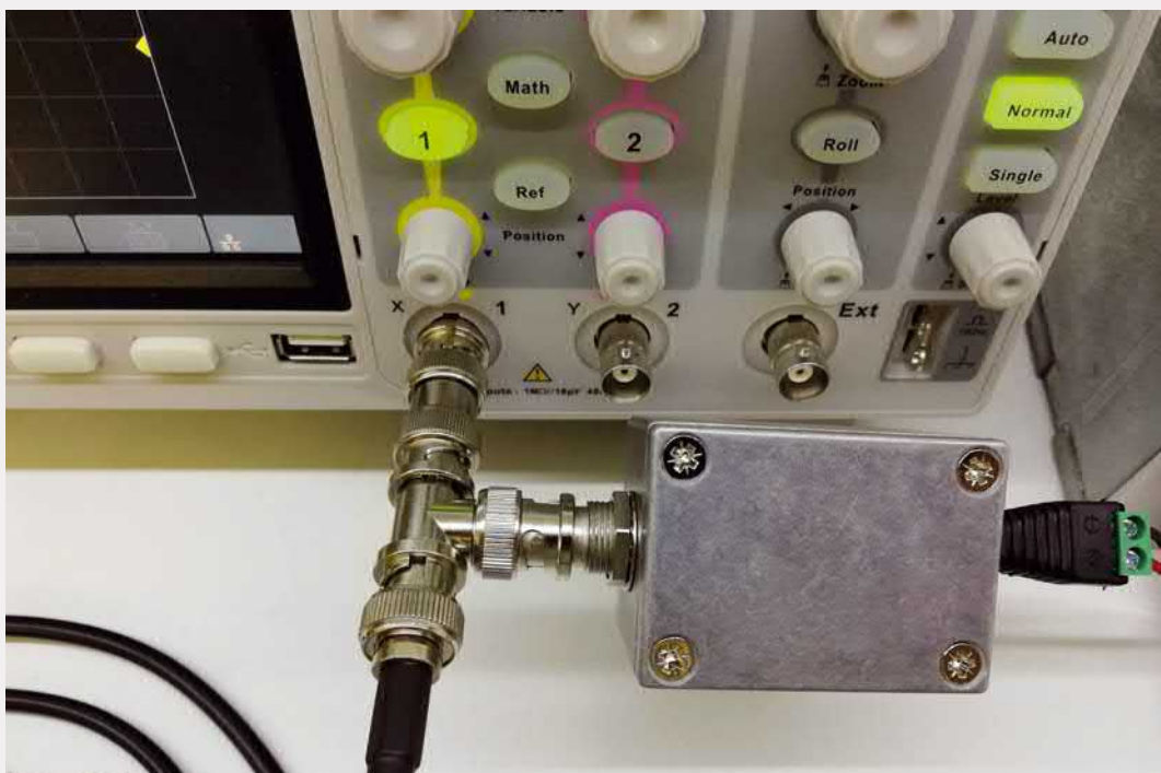
Fig. 7 Il setup delle misu- re: un BNC a T con- sente di iniettare il segnale all'ingresso dell'oscilloscopio e nel cavo testato.
