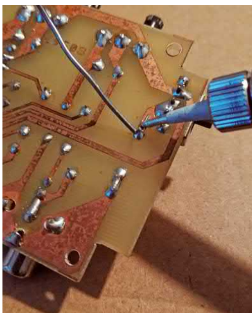
→ Fig. 4 Per saldare un componente appoggiate la punta per saldatore su reoforo e piazzola.
