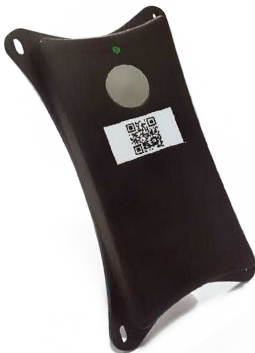
Fig. 2 Security IoT Box: notate il QR-code sul corpo, che serve per l'abbinamento.
