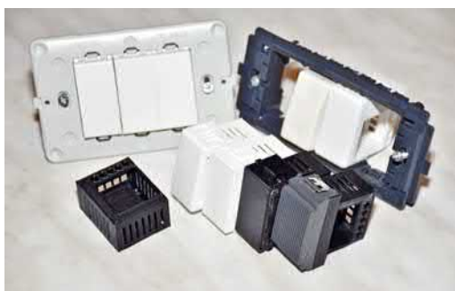
Fig. 7 Contenitori, adattatori e frutti stampati in 3D per placche Vimar Plana, Vimar Idea, Gewiss Basic e Gewiss PlayBus.
