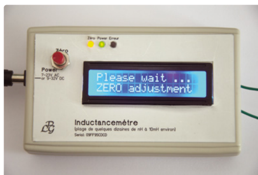
Fig. 3 Per garantire la massima precisione, ogni misura viene eseguita in due fasi. Qui è illustrata la fase 1, la sequenza di calibrazione del sistema.
