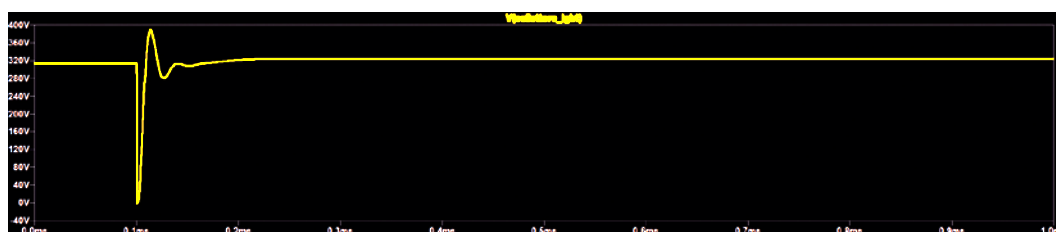
➔ Fig. 14e Andamento della tensione di Collettore_IGBT quando non sono presenti gli spacer.
