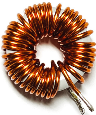
Fig. 7 Un induttore con nucleo toroidale in serie con il motore migliora il comportamento della BoB.
