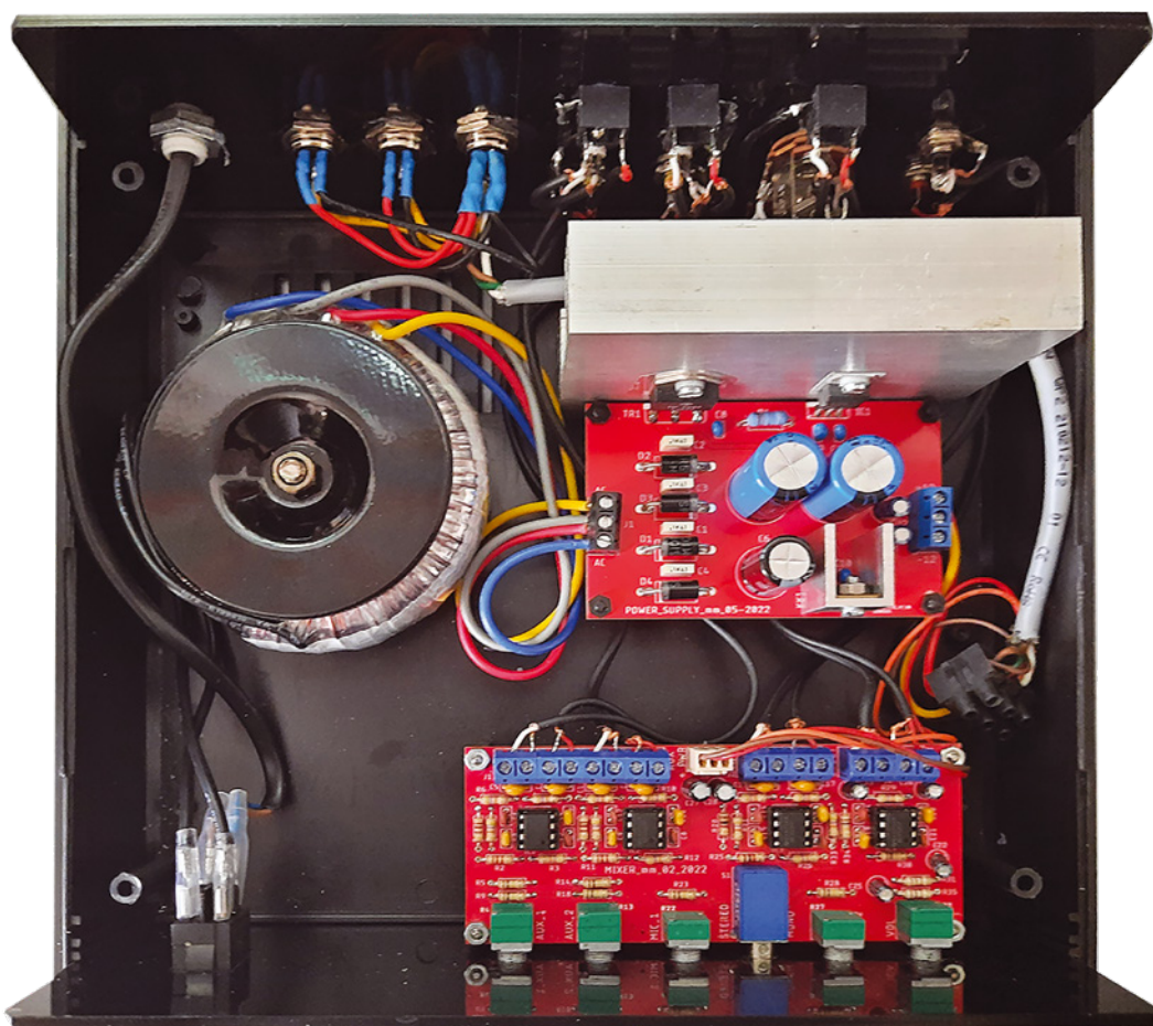
→ Fig. 5 Mixer e alimentatore generale montati nel contenitore
