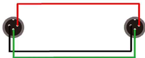
Fig. 17 Schema di realizzazione dei tre cavi di alimentazione esterna.
