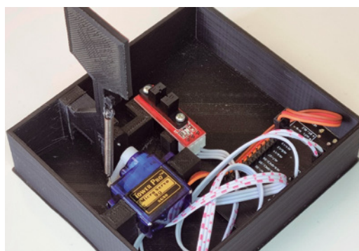
→ Fig. 2 Parti meccaniche assemblate con il servo.
