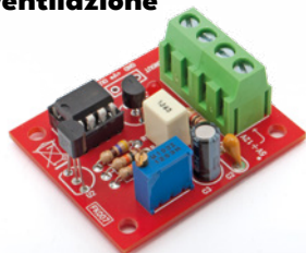
Scheda di controllo automatico per ventilazione
