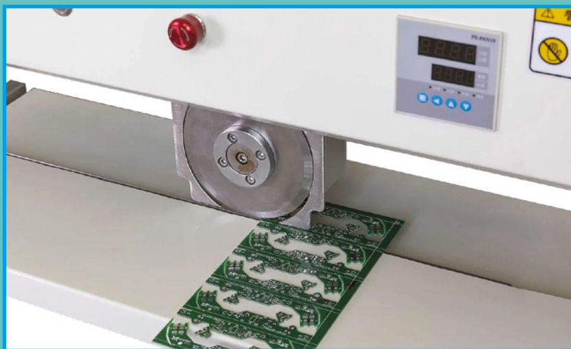
↑ Separazione dei singoli circuiti stampati con taglio mediante lama a disco.
