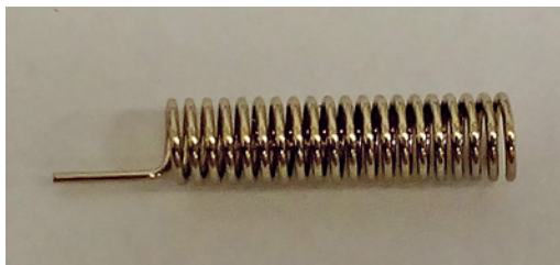
Fig. 3 Antenna a spirale accordata per il modulo.
