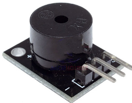
Fig. 9 Modulo buzzer KY012.
