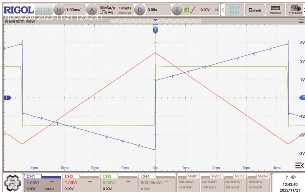
Fig. 9 Traccia tipica di un induttore.
