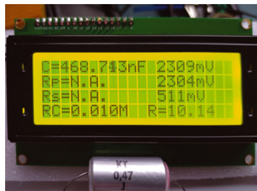
Fig. 4 Letture ottenute con diverse pendenze della tensione di alimentazione U(t) , con i valori del resistore di shunt R determinati automaticamente. Con stima di un resistore in serie R_s = 187 \Omega (a sinistra), e senza di esso (a destra).
