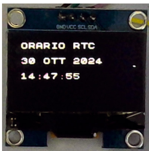
Fig. 11 Il display OLED con l'orario RTC.
