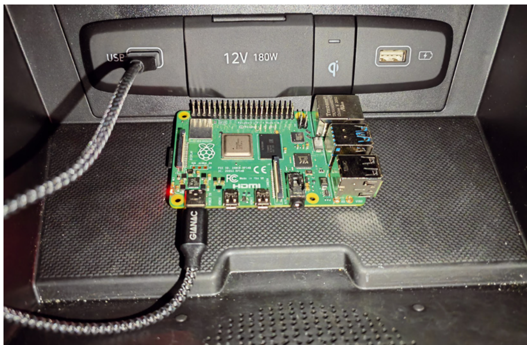
Fig. 1 Il Raspberry Pi 4 diventa il dongle per Adroid Auto.
