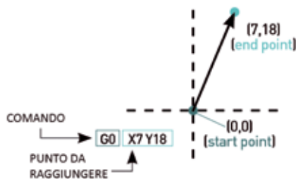
Fig. 3 - Schematizzazione dei comandi G-code.
