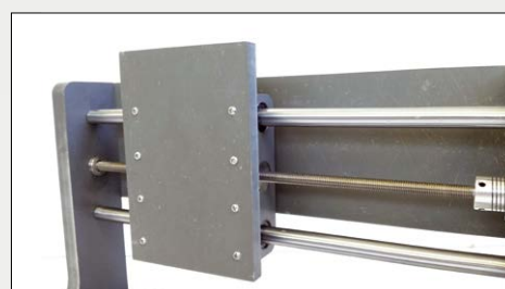
Fig. 11 - Il supporto per la testa portautensile.
