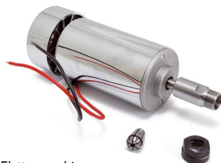
Elettromandrino smontato con in evidenza l'autocentrante (in basso) e la ghiera di serraggio).
