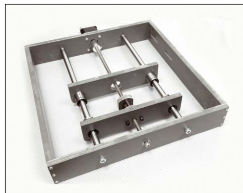
Fig. 7 - La base del telaio assemblata.
