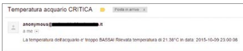
Fig. 7 - Esempio di e-mail inviata a seguito di una temperatura critica.
