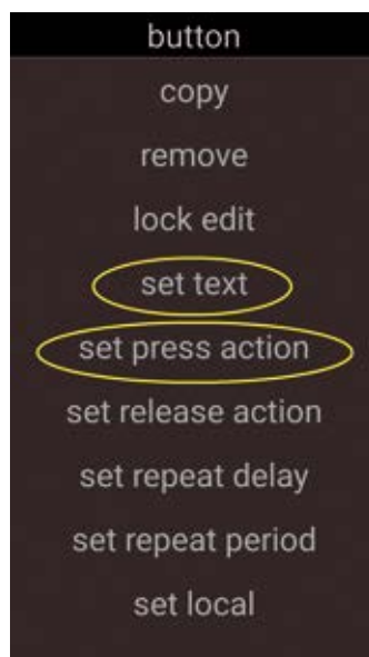
Fig. 5 - RoboRemo opzioni del widget button.
