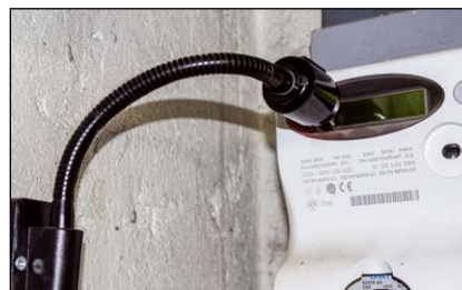
Fig. 10 Fotoresistori applicati al contatore e collegati con fili inseriti in un tubo flessibile.
