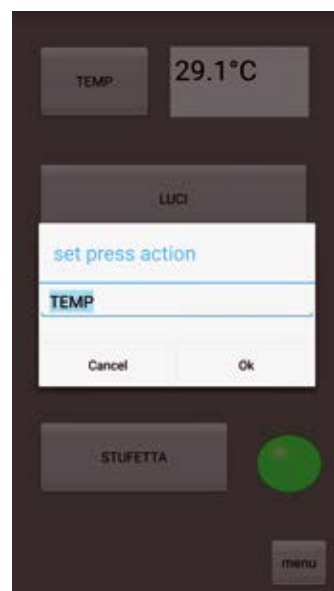
Fig. 6 - Azione svolta dal pulsante quando viene tappato.
