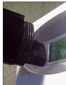
I due fotoreistori racchiusi in tubetti di termorestringente (all'interno del quale si trovano anche i resistori fissi) uniti e collegati alla Fishino.
