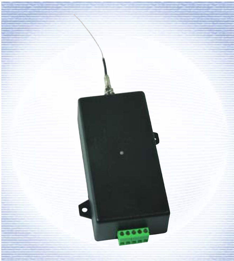
Come antenna abbiamo utilizzato uno spezzone di filo rigido da 8,5 cm montato su una spina FME. Nel caso in cui il "campo" sia molto basso è consigliabile utilizzare un'antenna esterna bibanda di tipo commerciale che garantisce un guadagno sicuramente superiore.
