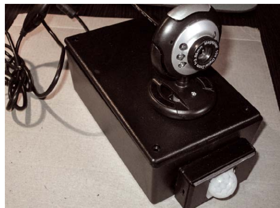
Fig. 1b - Webcam con brandeggio e PIR per rilevazione intrusione.
