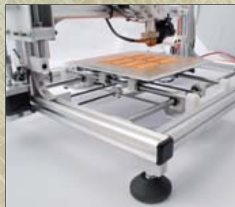
Il movimento è di tipo X/Y grazie a un nostro sistema di barre e cinghie.
