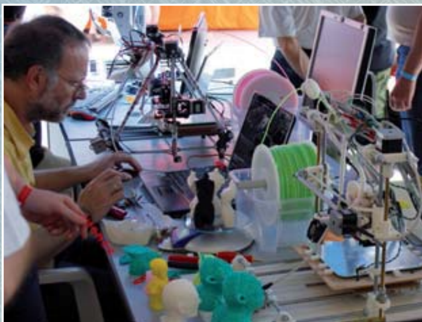
Le due nostre prime stampanti a confronto durante l'Arduino Flash Mob di metà giugno 2012. Prusa Mendel e Galileo versione "SM" fianco a fianco che stampano con pari qualità e velocità oggetti di ogni genere, piccoli e grandi.
