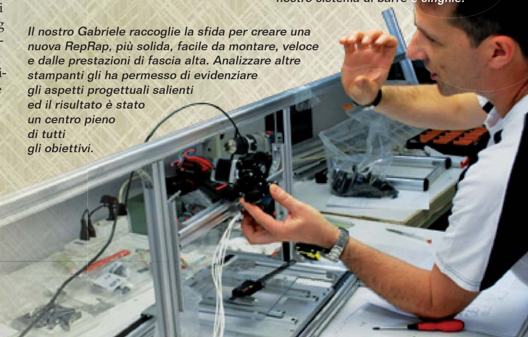
Il movimento è di tipo X/Y grazie a un nostro sistema di barre e cinghie.
