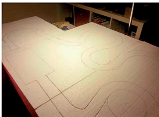
Fig. 2 - Preparazione della base del plastico, ottenuta scavando del polistirolo espanso.
