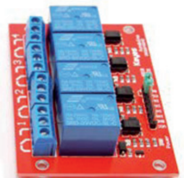
L'elettronica componente Irrighino: a sinistra Arduino Yún con su lo shield d'interfaccia con deviatori, LED e scheda a relé; a destra la scheda 4 relé da noi utilizzata per comandare le elettrovalvole.
