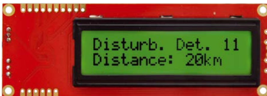
Fig. 2 - Rilevamento di 11 fulmini a una distanza stimata di 20 km.
