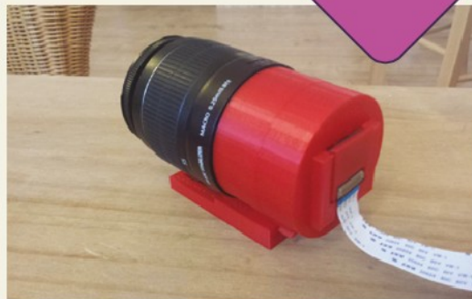
▲ Usando un adattatore per obiettivi stampato in 3D, puoi usare potenti obiettivi con un modulo fotocamera Raspberry Pi standard
