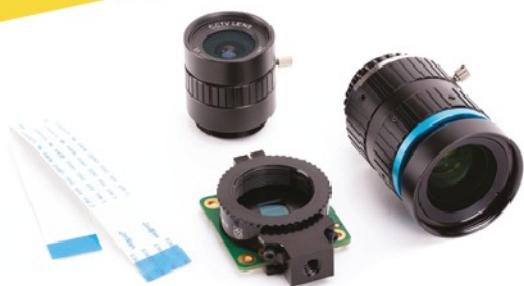
▲ La Raspberry Pi High Quality Camera si può usare con diversi obiettivi
