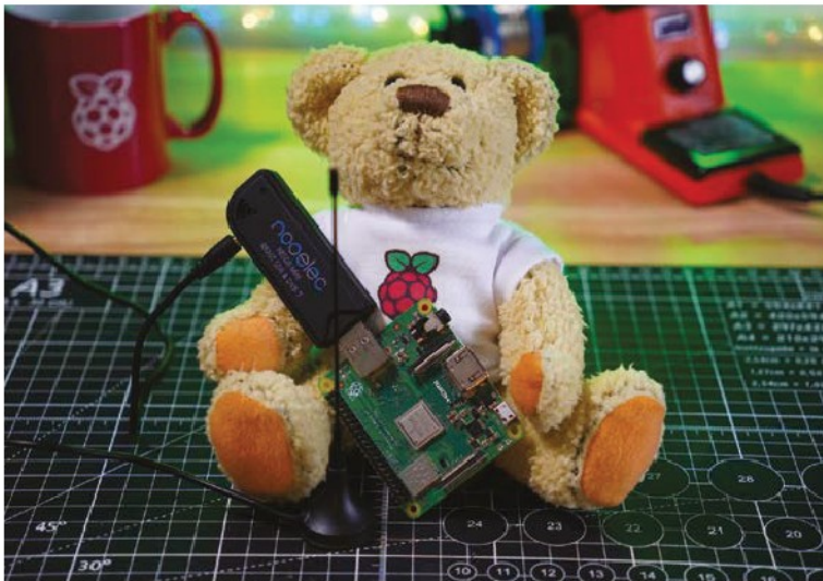
▲ Babbage tiene Raspberry Pi completo di dongle. L'antenna serve per rilevare i segnali dei transponder
