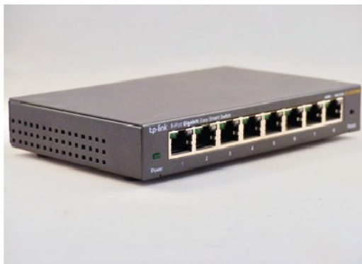
▲ Uno switch economico dedicato accelera le comunicazioni. I computer Raspberry Pi 4 traggono vantaggio della larghezza di banda Ethernet Gigabit
