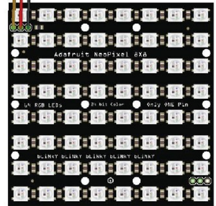
◀ Figura 3: Il pannello è collegato ai pin VSYS, GND e GPIO18 di Pico
