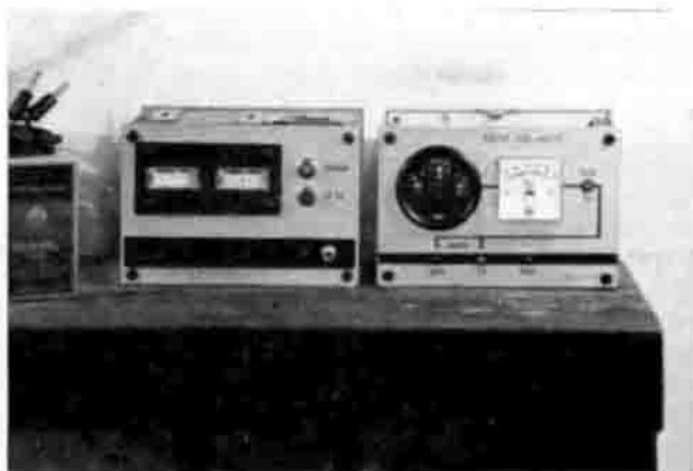
Prototipo della centralina del generatore a vento, con il caricabatteria automatico.
