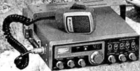
rtx mobile 480 canali 7W FM - 7W AM - 15W SSB (120ch. FM - 120ch. AM 120ch. USB - 120ch. LSB) mod. 7001
