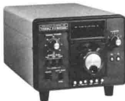
FV 901 DM synthesized scanning external vfo questo apparato esplora per voi la banda sino a trovare un segnale perfetto per i vostri DX. È dotato anche di un piccolo computer che può memorizzare fino a 40 frequenze.
