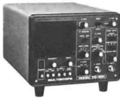
YO 901 multiscopes monitor per rilevare il segnale trasmesso ed il segnale ricevuto.
