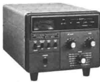
FTV 901 VHF/UHF Oscar Transverter è un convertitore per i 144/148 MHz che dà la possibilità sui 2 metri di operare con satelliti Oscar per i vostri QSO
