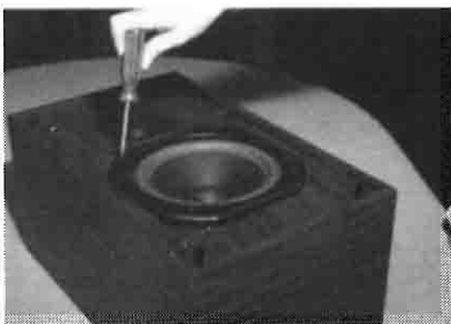
Fissaggio del woofer sul frontale della cassa.
