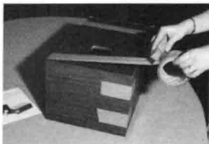
Il fissaggio provvisorio del pannello posteriore mediante nastro adesivo teso tra due fiancate opposte.
