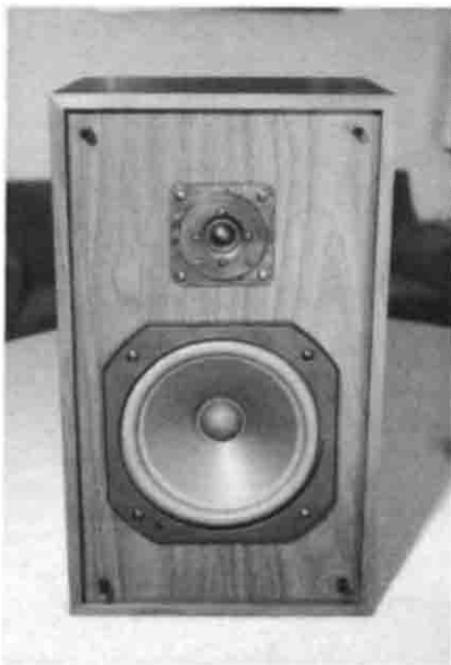
Fissaggio del woofer sul frontale della cassa.
