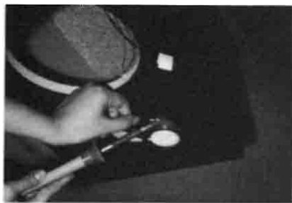
Individuazione dei terminali di woofer e tweeter; saldatura e fissaggio degli altoparlanti sul frontale del diffusore.
