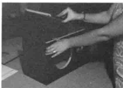
L'installazione del pannello frontale e la chiusura della fascia perimetrale del mobile.
