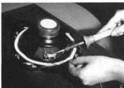
La saldatura dei terminali del woofer.
