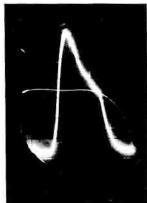
Foto 6 - Curva tipica di M.F. ottenuta con la minima deviazione di frequenza.
