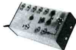
KL 48 Generatore di impulsi TTL e DTL. Clock selezionabile fra 100, 50, 10, 5 e 1 Hz.
