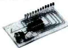
KH 50 Vumetr a Led, sensibilità max = 1 V - min. = 7 V. L. 9.800
