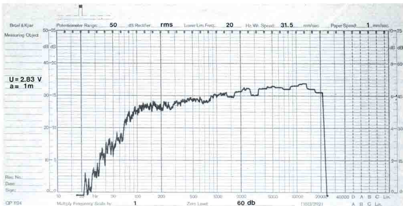
Fig. 7 - K-60 risposta in frequenza rilevata con «rumore rosa filtrato a terzi d'ottava» in camera anecoica, ad 1 m sull'asse.
