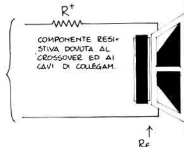
Fig. 8 - La componente resistiva R^+ , posta in serie al woofer e dovuta al «passa-basso» del filtro crossover modifica il QES ed il QTS del trasduttore.
