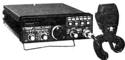
FT 480 R: ricetrasmittitore per i due metri in SSB-CW-FM da 143,500 a 148,500 Mhz -30 W PEP - doppio VFO - 4 memorie - speciale per satelliti.
