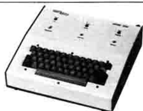
Tastiera 3 funzioni CW RTTY - ASCII - da 4 a 25 parole al minuto (W.P.M.) con inserimento di 1 W.P.M. Tasti speciali: AS - BK - BT - AF SK - CO - DE Alimentazione: 220 V Ac.
