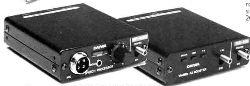
Come gli SPEECH PROCESSOR RX 110 e RF 660 che incrementano notevolmente la potenza di inviluppo.
