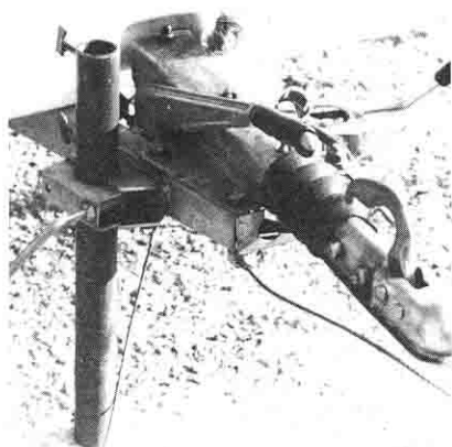
Fig. 9 - L'antenna versione 2: l'attacco alla caravan.
