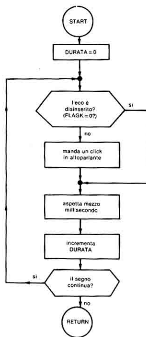
Fig. 3 - Diagramma di flusso della subroutine che misura la durata di un segno.
