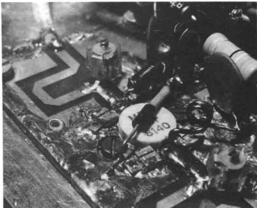
Fig. 8 - Il montaggio ultimato. Notare i condensatori «Glimmer» saldati vicinissimi alla base e al collettore del transistor, il condensatore passante C_{10} saldato sul circuito stampato e la posizione dei compensatori C_1 e C_2 . Il diodo D_2 , visibile ricoperto di pasta termoconduttrice.
