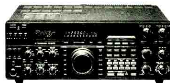
TS940S - Ricetrasmittitore HF LSB - SSB - CW - FSK - AM / 80 W
