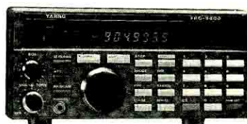
FRG 9600 - Ricevitore A Copertura continua da 60 a 905 MHz
