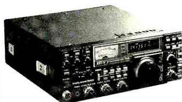
IC751A - Ricetrasmittitore FM / SSB CW - AM - FM - FSK/100W
