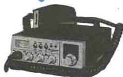
ALAN 69 34 canali AM-FM; potenza 4,5 W; frequenza 26.875-27.265 MHz; alimentazione 12,6 V.
