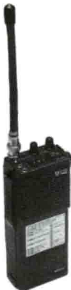
ICOM IC-02E Ricetrasmittitore portatile 140-150 MHz - FM Potenza RF 5 W - 10 memorie.
