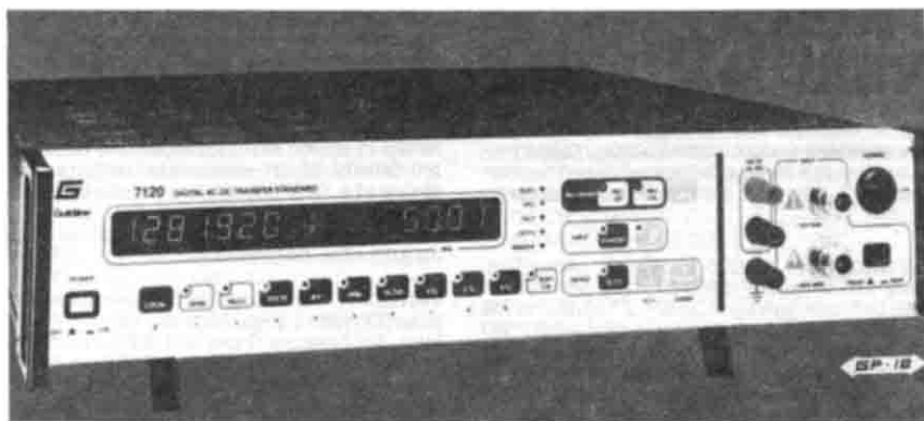
7120 Guildline per ranges 100 mV + 1200V a frequenze 40 Hz + 1 MHz (fattore di cresta 4:1); risoluzione 1 ppm.
