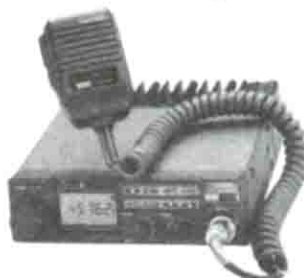
FT 211RH Ricetrasmittitore VHF/FM, 45 W, 138-174 MHz RX, 138-159 TX.
