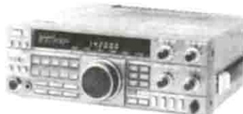
KENWOOD TS 440 S Ricetrasmittitore HF; tutte le bande amatoriali da 100 kHz a 30 MHz in AM-FM-SSB-CW, potenza 100 W in AM.
