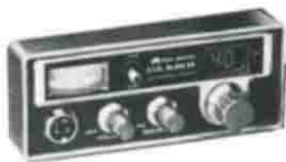
Ricetrasmittitore veicolare o base AM/FM; omologato; 40 canali; freq. 26.965 - 27.405; pot. 4 W; alim. 13,8 Vcc.
