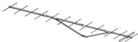
20113 13 elementi 144/146 MHz, 14,5 dB, ang. di apert. orizz. 2 x 18°, ang. di apert. vert. 2 x 33°, rapp. avanti-indietro 20 dB, imp. 50 Ω, ros ≤ 1,2, lungh. m 4,45.
