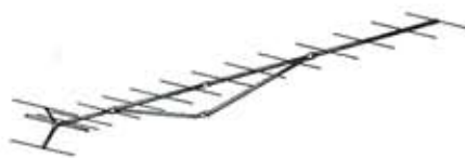
20116 16 elementi 144/146 MHz, 16,5 dB, ang. di apert. orizz. 2 x 16°, ang. di apert. vert. 2 x 17°, rapp. avanti-indietro 22 dB, imp. 50 Ω, ros ≤ 1,2, lungh. m 6,4.
