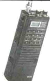
ICOM IC-02 E IC 02 EAT Ricetrasmittitore VHF/FM da palm 1 W, 10 memorie, circuiti «Power Save» per una maggiore autonomia, dimens. ridottiss.: 58 x 140 x 29 mm, peso g 340, visore a cristalli liquidi illum., blocco della freq.
