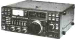
ICOM IC 271 (25 W) ICOM 271 H (100 W) Ricetrasmittitore VHF-SSB CW-FM-144 - 148 MHz. Sintonizzatore a PLL, 32 memorie, potenza RF 25 W regolata da 1 W al valore max.
