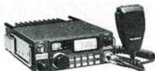
YAESU FT 290 RII Portatile VHF SSB-CW-FM Potenza 2,4 W (optional, amplificatore da 25 W FL-2025)
