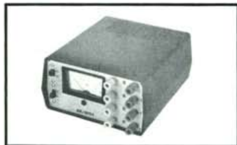
KP 134 ALIMENTATORE DA 10 A, tensione regolabile tra 11 e 15 V; variazione di tensione da vuoto a pieno carico 100 ± 200 mW; protezione elettronica incorporata. (RKE 6/84) L. 110.500
