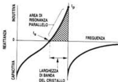
Fig. 3 - Andamento impedenza-frequenza tipico di un cristallo oscillante in fondamentale; f_s ed f_p sono rispettivamente le frequenze di risonanza serie e parallelo. La larghezza di bande per un quarzo a 4 MHz si aggira sui 5 \div 10 kHz.
