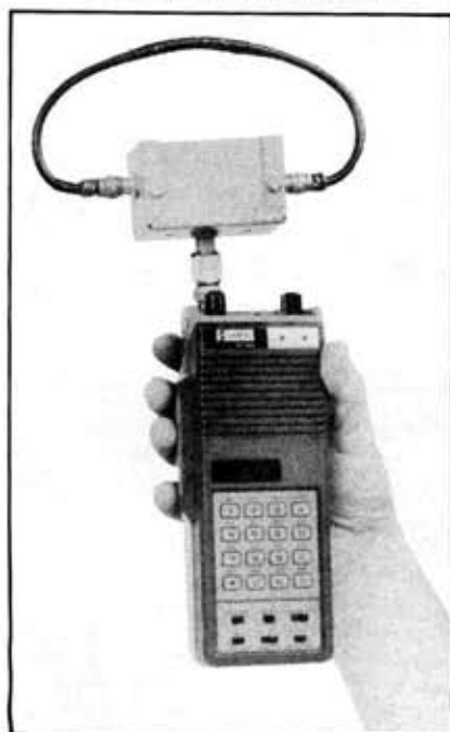
Foto 2 - Per usare il radiogoniometro, ruotare il ricetrasmittente fino a quando il segnale raggiunge il livello minimo: questo significa che l'antenna è orientata in direzione della sorgente del segnale.
