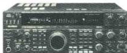
ICOM IC 781E RICETRASMETTITORE HF 0-30 MHz - 100 W TUTTI I MODI ANALIZZATORE DI SPETTRO INCORPORATO
