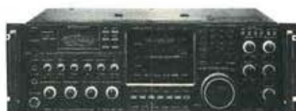
ICOM IC 781E RICETRASMETTITORE HF 0-30 MHz - 100 W TUTTI I MODI ANALIZZATORE DI SPETTRO INCORPORATO
