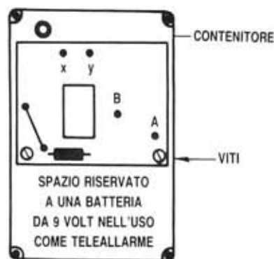
Fig. 5 - Sistemazione dei due moduli nei rispettivi contenitori.
