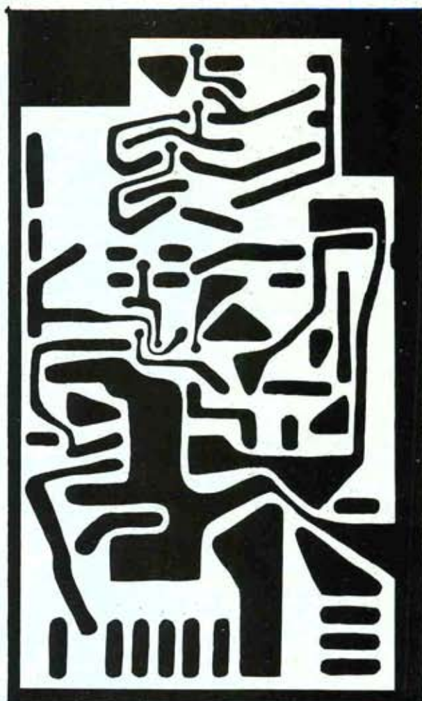
Circuito stampato scala 1:1 lato rame.
