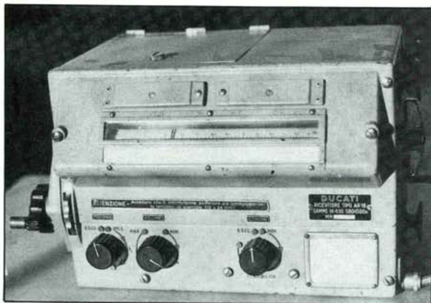
TX A320 Rx AR18 Questa la combinazione a bordo degli aerei plurimotori della Regia Aeronautica.
