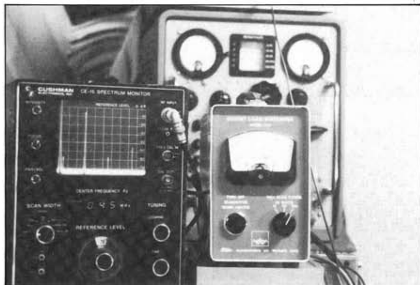
Foto Brevia a 28,600 MHz = 65 W input - 600 W output sul monitor di spettro si vede la 2 armonica attenuata di oltre 50 dB e la 3 armonica attenuata di 40 dB rispetto al picco di fondamentale divisione orizzontale - 10 MHz quattro - Divisione verticale 10 dB quadrato.
